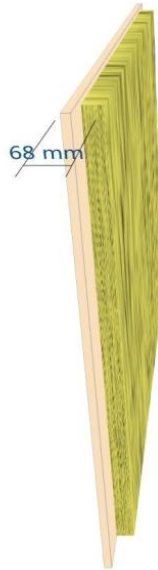
Figura 7.3: Referencia de la barrera de OSB con lana de vidrio al interior.
